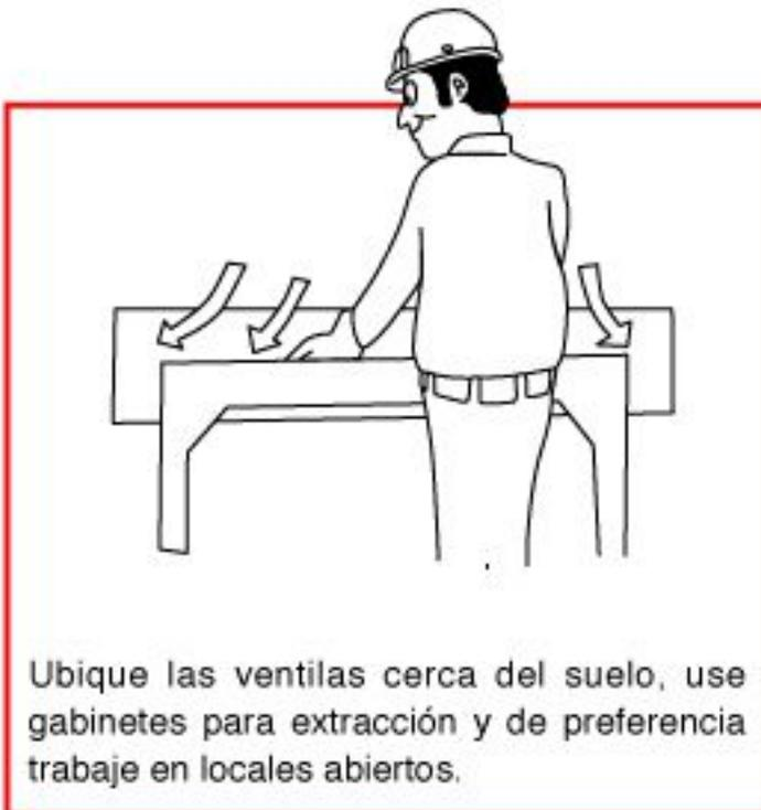
Ubique las ventilas cerca del suelo, use gabinetes para extracción y de preferencia trabaje en locales abiertos.
