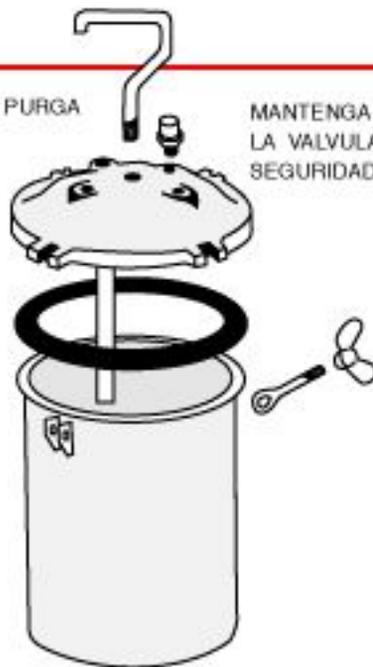
Evite que al lijar el polvo, ya sea de la resina y/o de la fibra, tape los orificios de alivio del tanque.
